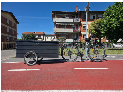
Prototipo attuale: Surly Ogre con motore Bafang + rimorchio Carry Freedom Y Large V2.2.
