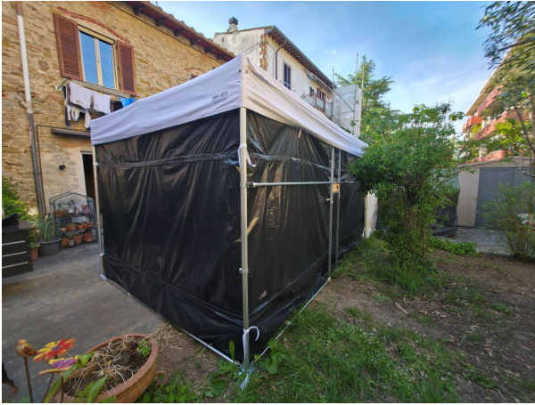
Montaggio esterno a scala reale. Gazebo modificato 3 x 4,5 m con teli oscuranti.
